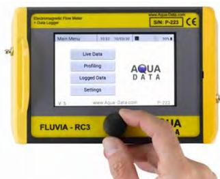
Doté d'une électronique moderne, l'interface utilisateur devient simple et intuitive, avec menus et écran sensitif,
