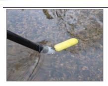
Le courantomètre électromagnétique **FloStick RC4** est un appareil portable regroupant sonde, perche et afficheur dans un même ensemble.
